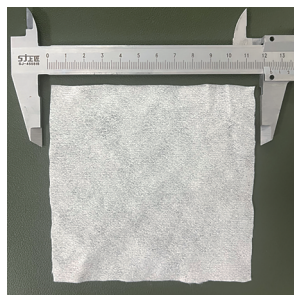
图1 增强层水刺无纺布材料
